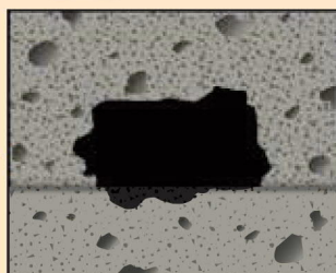
膨胀后的澎内传 止水条水化反应
